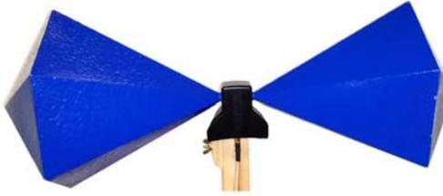
Fig. 4. Biconical antenna.
